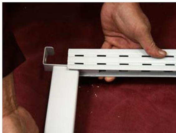
...поверните до защелкивания и вдвиньте в раму до упора.
